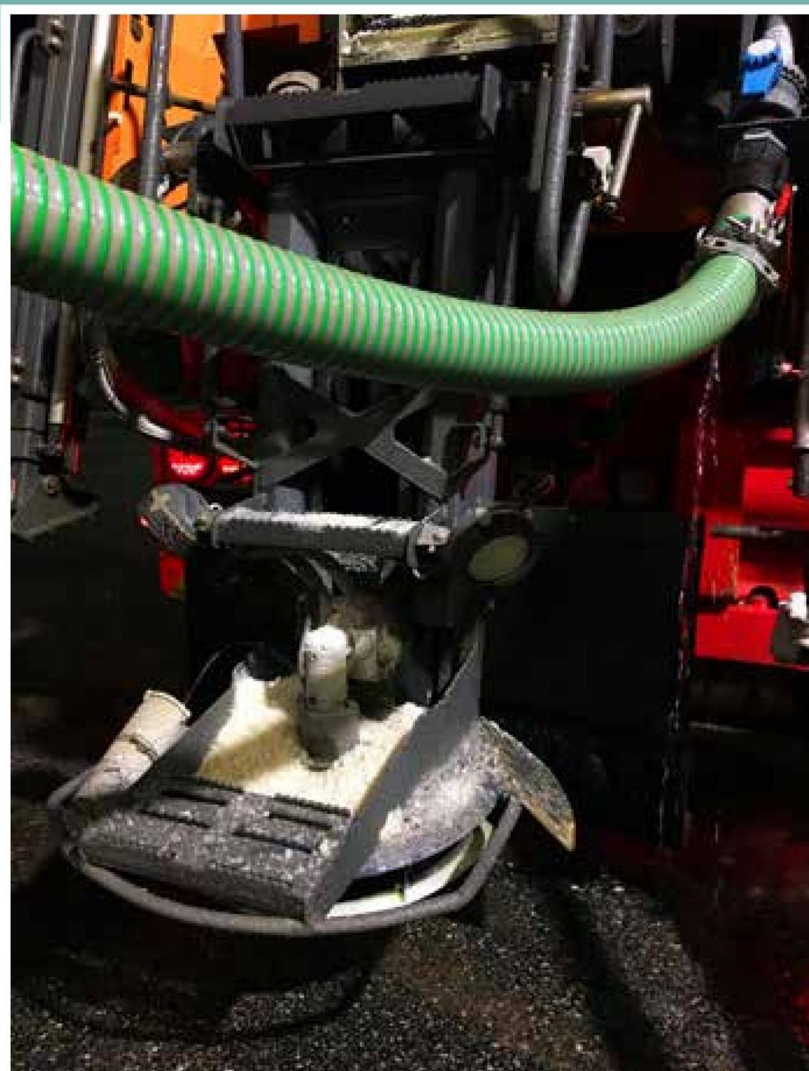
En del af ruterne er indkodet med GPS, hvilket betyder, at saltsprederen selv styrer, hvor meget salt der skal på vejene, hvor langt der skal spredes ud til siderne, og at der kun spredes salt på de nødvendige steder. Foto: Line Tornvig Martinussen
