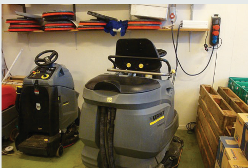
Forkert indretning. Brændbart oplag.
